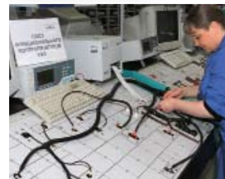
Все жгуты проводов проходят проверку на стенде. При обнаружении неисправности конвейер может быть остановлен
