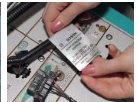
Наличие такой бирки говорит о том, что контролер несет ответственность за каждый разъем, провод, клемму
